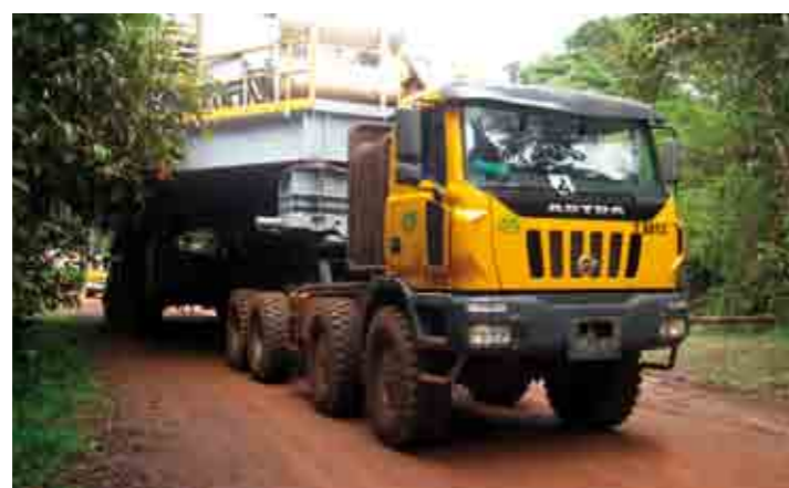
8x8 tracteur boîte 165221 et WSK440 avec refroidissement supplémentaire 8x8 tractor cambio 165221 y WSK440 con enfriamiento adicional
