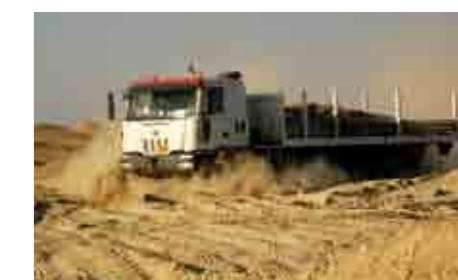
HHD 6x6 empattement extra long 6100mm, cabine longue, boîte de vitesses 165221 avec WSK440 et système de gonflage/dégonflage pneus depuis le poste de conduite HHD 6x6 paso extra largo 6100 mm, cabina larga, cambio 165221 con WSK440 y sistema de inflado/desinflado de los neumáticos desde el puesto de conducción
