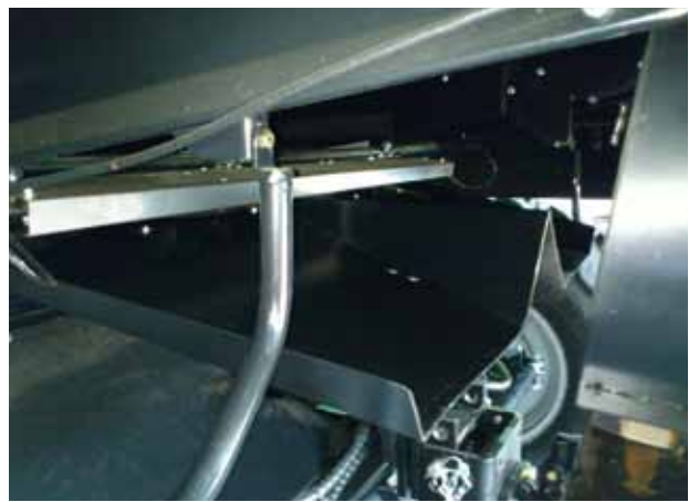
Nuevo transportador de granza con rampas metálicas que canalizan la granza hacia los rotores de cuatro álabes.
