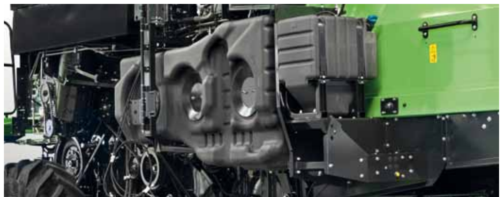
Depósitos de combustible y de AdBlue® de polietileno de 10 mm de espesor.
