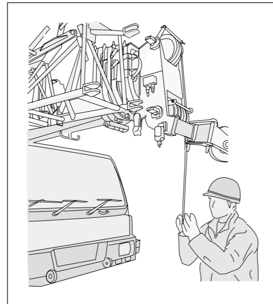
Figura 5-17 Figura de tirar hacia exterior la cuerda de acero
