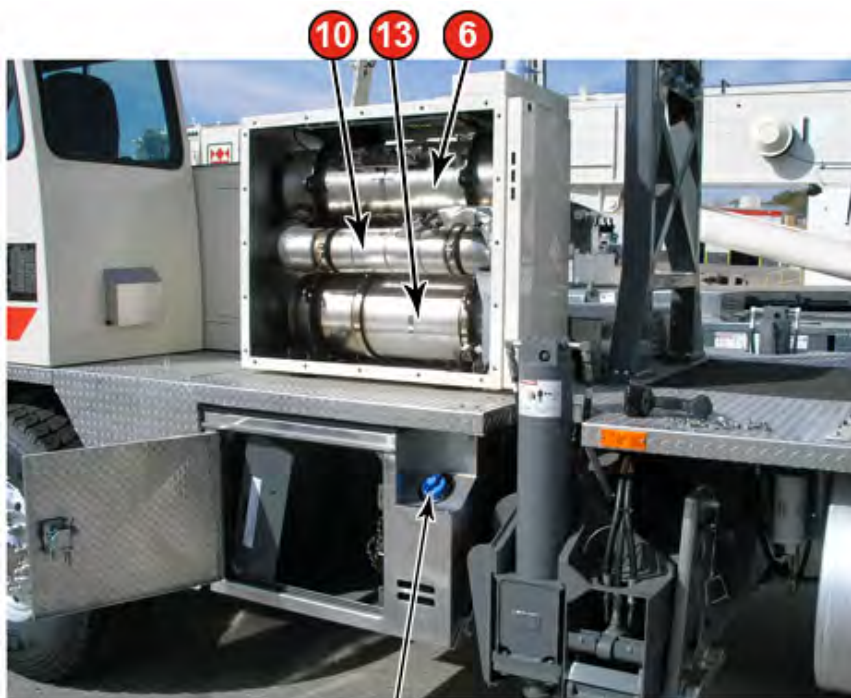
DEF (UREA) FILL TANK
