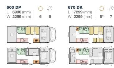
LENGTH 6990 - 7299 mm WIDTH 2299 mm HEIGHT 3070 mm WEIGHT 3500 kg FIAT 6D ENGINE 2,2 140 / 160 / 180 HP
