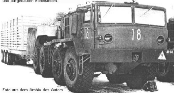
MAZ-537 mit dem Auflieger TshMZAP-9990 und aufgebauten Bordwänden.
