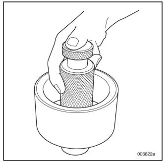
Figure 446 — Installing Teflon<sup>®</sup> Seal
