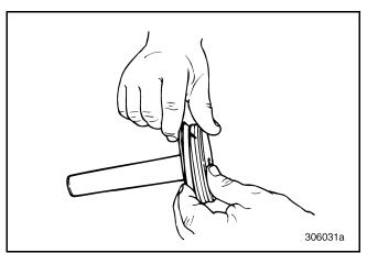
Figure 451 — Installing Teflon<sup>®</sup> Seal
