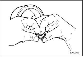
Figure 443 — Forming Teflon<sup>®</sup> Seal
