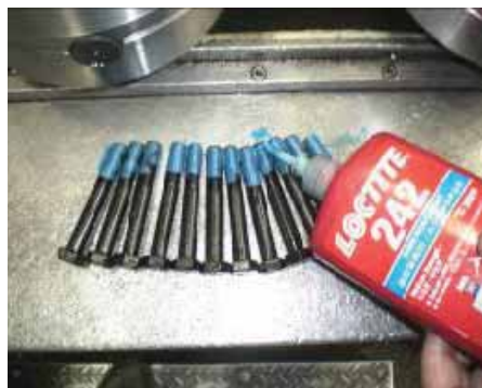
(6) Смажьте резьбы герметиком
