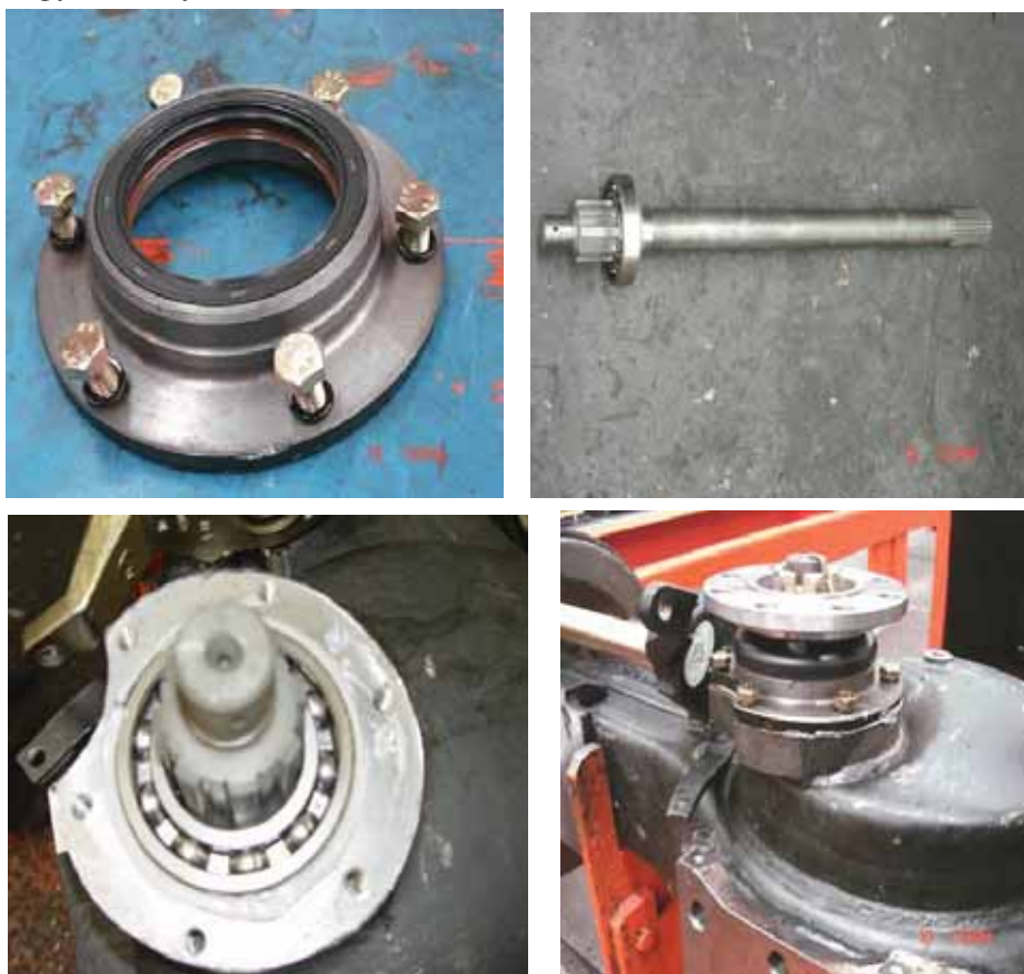
Процедура 13: Установка вала, соединяющего приводы двух ведущих мостов; блока подшипников и фланца
