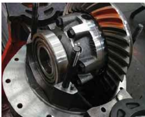
(8) Установка двух внешних колец подшипников завершена. Дифференциал не должен быть наклонен. Слегка заверните регулировочные гайки, чтобы создать предварительное нагружение подшипника.
