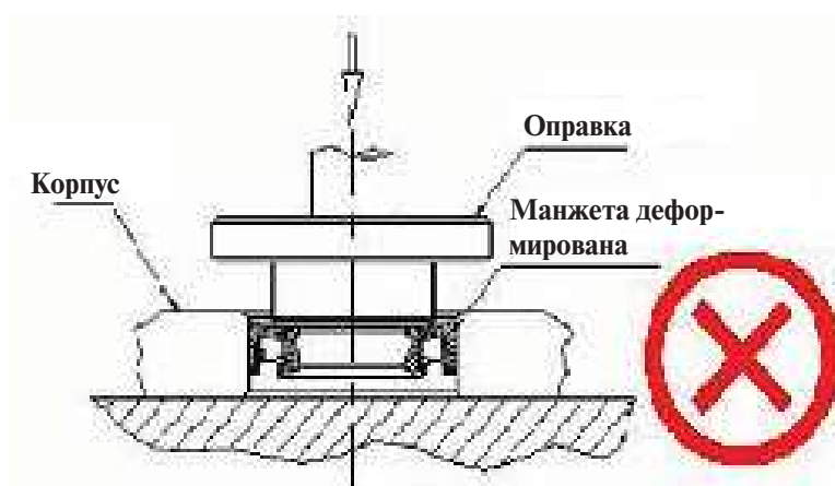
Рис. 2-9 Перед продвижением в отверстие манжета была слишком сильно наклонена
