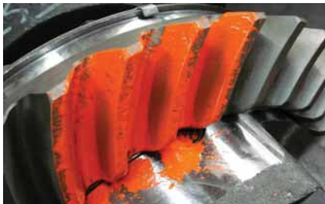
Рис. 2-25 Коррекция пятна контакта конической шестерни
