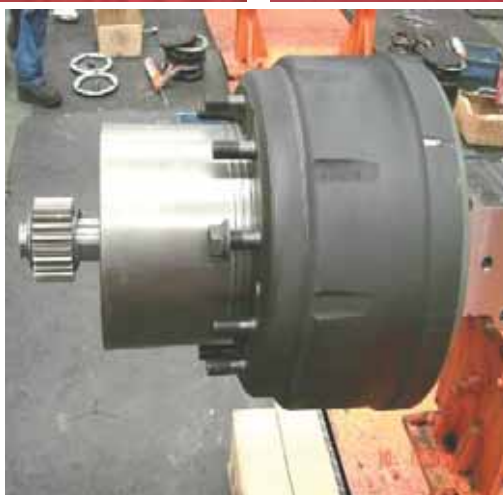
Процедура 10: Установка полуоси и солнечной шестерни
