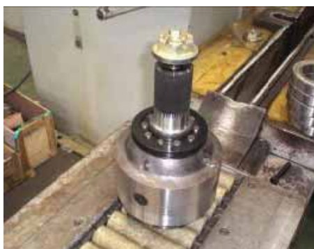
(8) Установите кольцо со штифтами блокировки дифференциала
