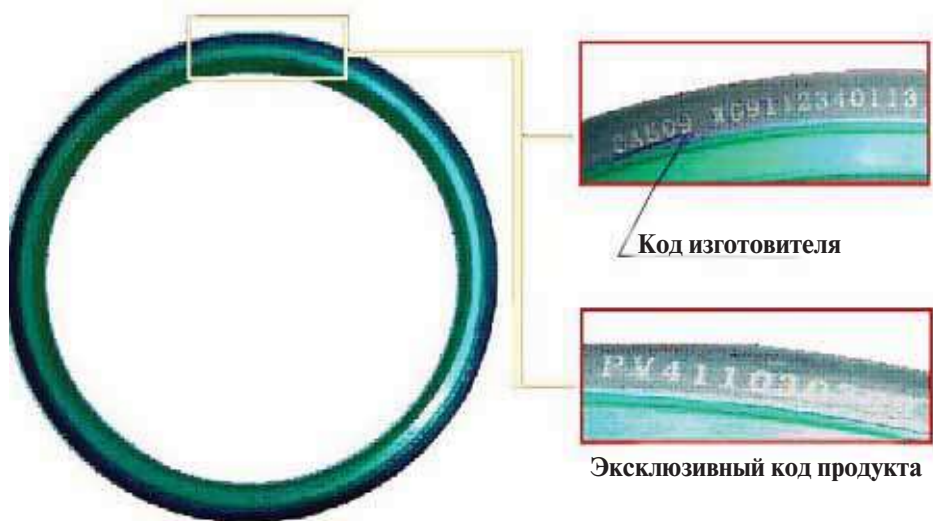
Рис. 1-6 Масляное уплотнение ступицы
