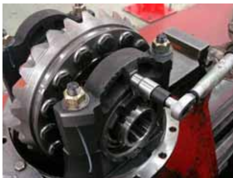
(15) С помощью отвертки поверните фиксирующую деталь, затем слегка постучите по ней, чтобы убедиться в работоспособности механизма блокировки.
