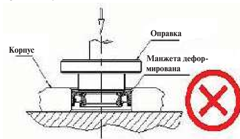
Рис. 2-8 Внутренний диаметр оправки слишком мал
