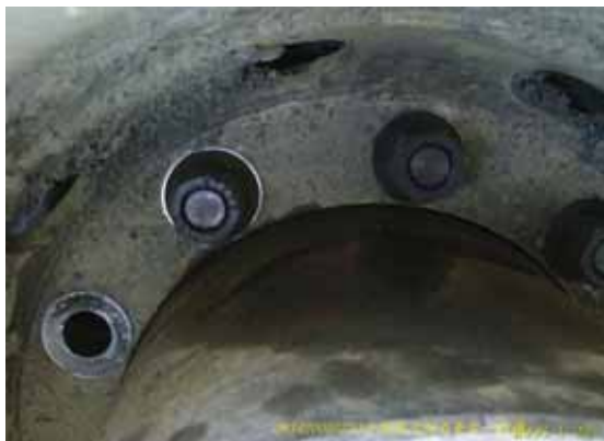
Рис. 2-20 Сломанный колесный болт
