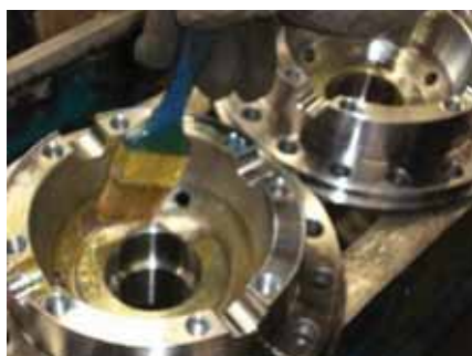
(1) Смажьте маслом внутренние полости корпуса дифференциала
