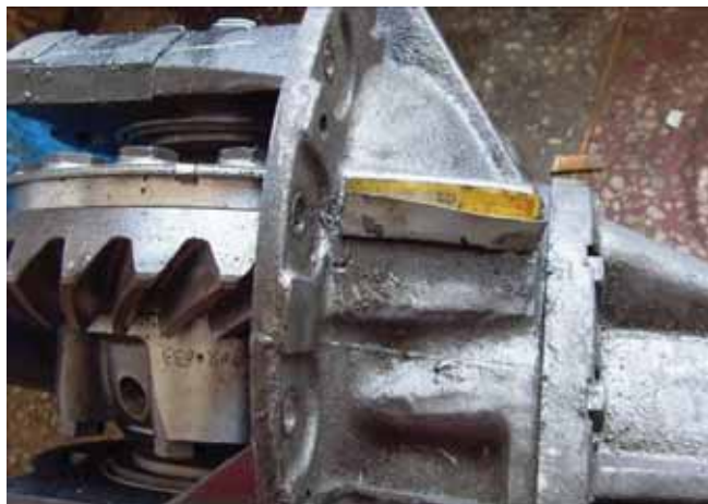
Рис. 2-18 Утечки из картера главной передачи (из-за песчаных раковин под табличкой)
