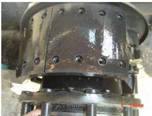
Рис. 2-33 Масляное пятно на тормозной накладке
