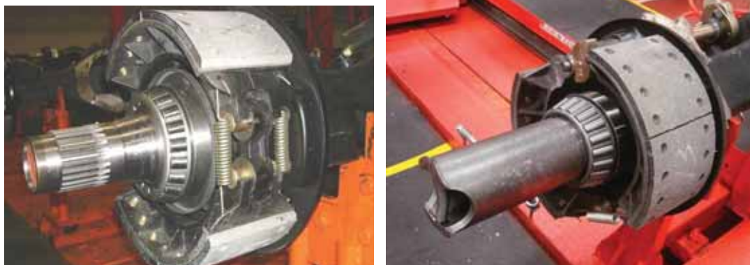
Процедура 6: Установка разделительного кольца и подшипников ступицы колеса
