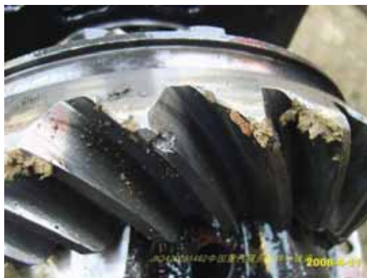
Рис. 2-27 Излом зубьев конического зубчатого колеса
