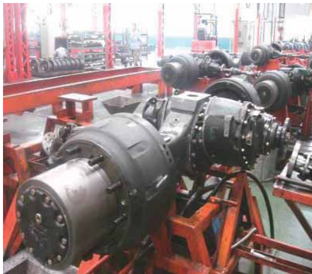
Процедура 14: Завершение сборки моста
