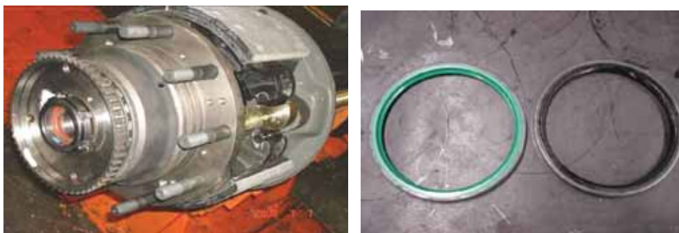
Процедура 7: Установка задней ступицы, кронштейна и зубчатого колеса
