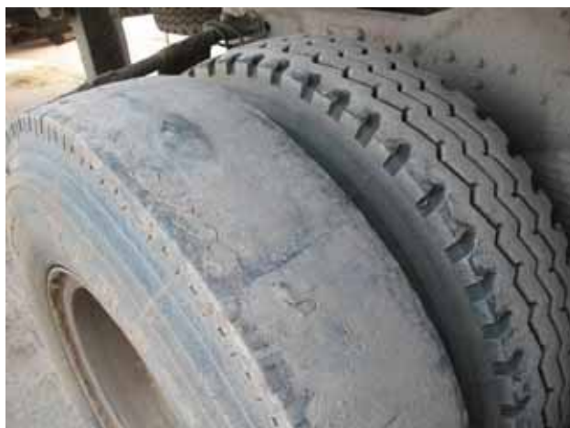
Рис. 2-24 Несимметричный износ шин вследствие деформации картера моста
