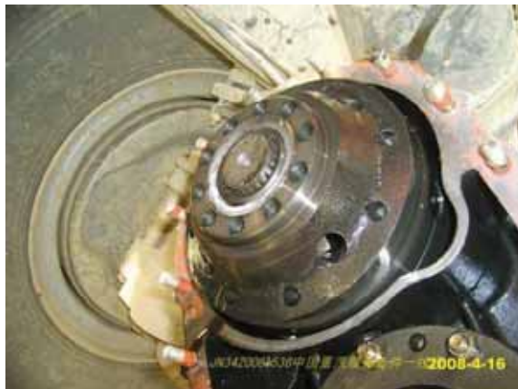
Рис. 2-30 Излом деталей на входе в межосевой дифференциал
