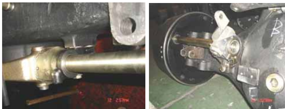
Процедура 4: Установка вала эксцентрика, кронштейна вала и регулировочного рычага тормозного механизма
