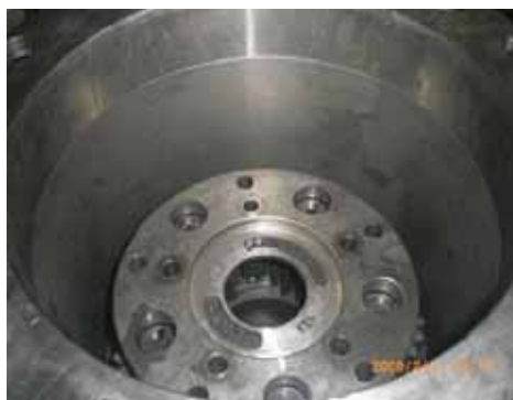
(2) Снимите болты волила
