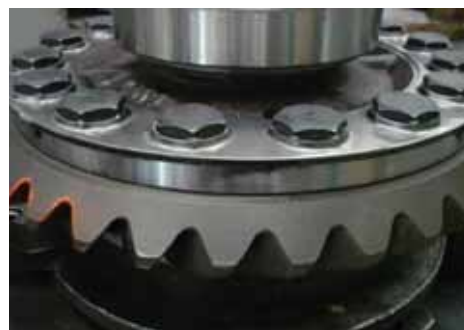
(2) Установите фиксирующие элементы и подшпнник
