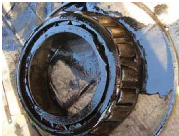
Рис. 2-22 Деформация сепаратора подшипника
