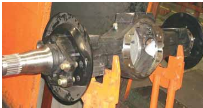
Процедура 1: Позиционирование картера моста, а также установка верхней и нижней арочных скоб
