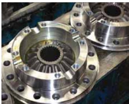
(3) Установите шестерню полуоси
