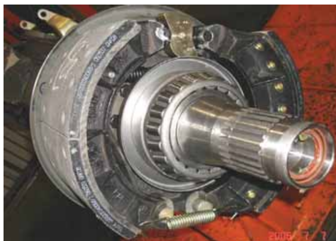
Процедура 5: Установка тормозной колодки в сборе
