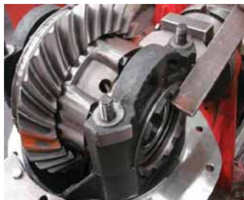
(8) Установка двух внешних колец подшипников завершена. Дифференциал не должен быть наклонен. Слегка заверните регулировочные гайки, чтобы создать предварительное нагружение подшипника.
