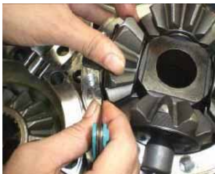
(5) Проверьте зазор (от 0,6 до 1,0 мм)
