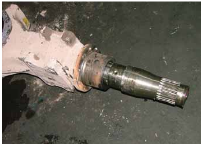
Рис. 2-13 Биения головки литого корпуса трехсекционного моста
