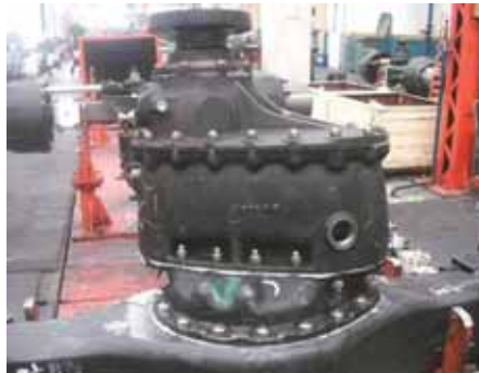
Процедура 11: Установка главной передачи
