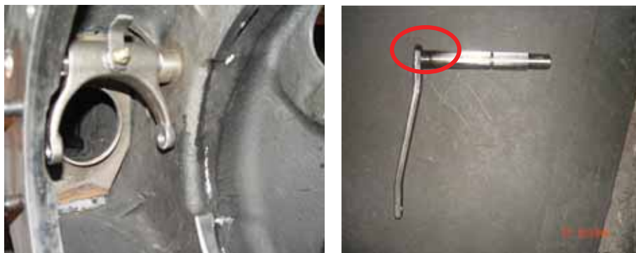
Процедура 3: Установка штока дифференциала и вилки переключения
