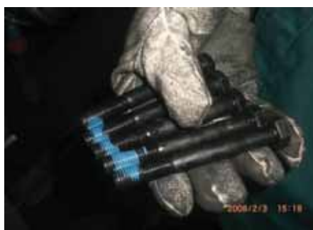
(4) Смажьте резьбы герметиком
