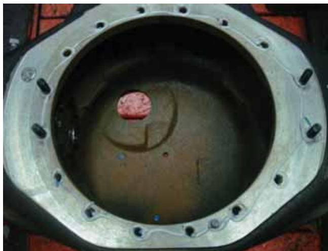
Рис. 2-17 Нанесение герметика на контактную поверхность картера моста
