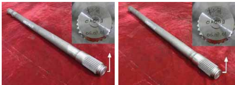
Рис. 1-15 Полуось ведущего моста серии STR
