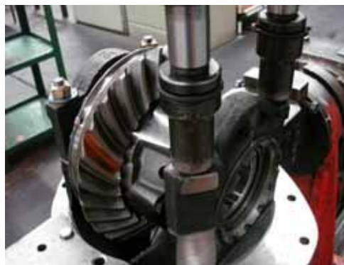
(12) Затяните гайки крышки до момента 210~260 Н•м.
