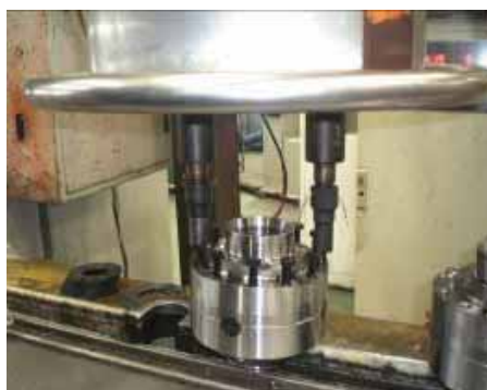
(7) Выполните предварительное нагружение, прилагая одинаковое усилие с противоположных сторон
