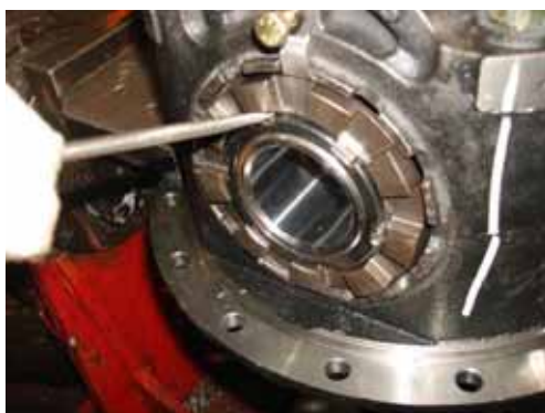
(13) Установите замыкающую пластину и проверьте момент затяжки (21~25 Н•м).
