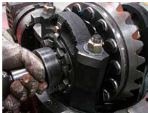
(14) Установите неподвижную зубчатую полумуфту блокировки (момент затяжки равен 200~240 Н•м).
