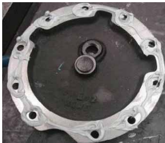
Рис. 2-2 Нанесение герметика на концевую крышку колеса
