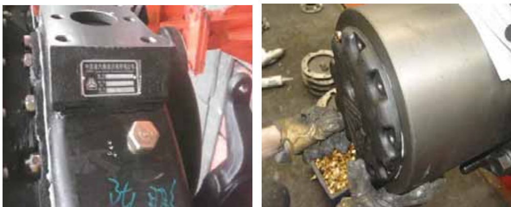
Процедура 12: Установка концевой крышки колеса и заклепывание таблички.
