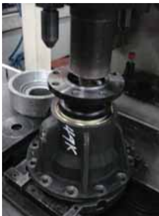
(5) Установите блок подшипников в сборе. Предварительное нагружение должно быть равно 1~2 Н•м.
