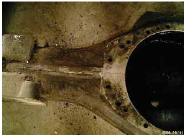
Рис. 2-19 Продольная трещина в картере моста
