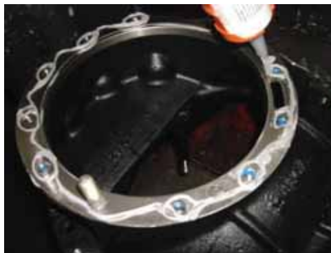
(6) Нанесите фиксирующий состав на резьбовые отверстия картера главной передачи. Плоскость сопряжения должна быть смазана герметиком, устойчивым к воздействию масла.
