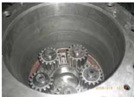
(3) Проверьте сборку механизма колесного редуктора
