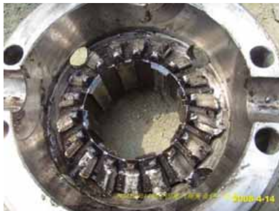
Рис. 2-29 Излом зубьев шестерни полуоси дифференциала
