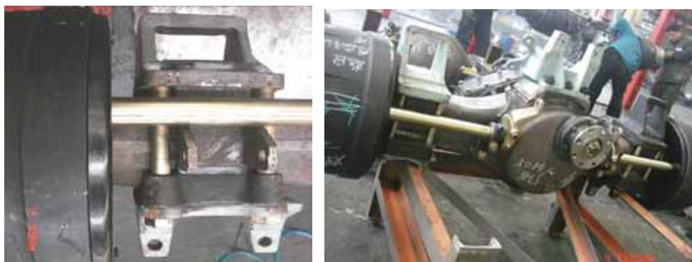
Процедура 15: Установка кронштейна
