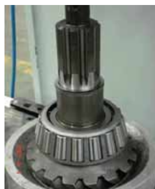
(4) Установите подшипник ведущей вал-шестерни
