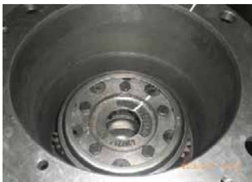
(5) Установите водило вместе с диском, задерживающим масло, в первоначальное положение. Затяните болты, соблюдая принцип симметрии. Момент затяжки: 113~137 Н•м
