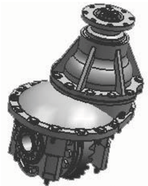
Рис. 1-3. Общий вид главной передачи
