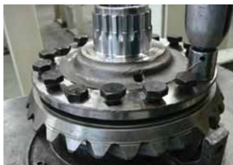
(1) Выполните сборку ведомого конического колеса с дифференциалом
