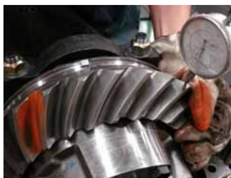
(10) Проверьте боковой зазор, который должен быть отрегулирован в пределах 0,25~0,45 мм.
