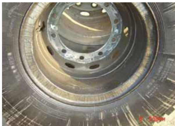
Рис. 2-11 Утечки через песчаные раковины
